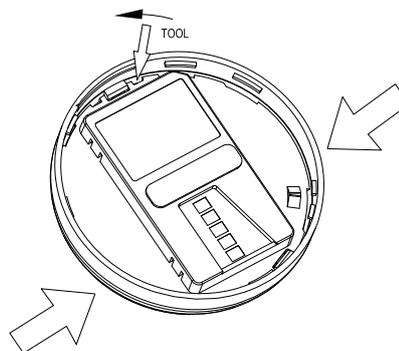
Remova a tampa, abra a câmara do detector e limpe-a cuidadosamente.
