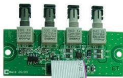
**FOM-2000-SP Módulo de adição de rede de fibra óptica** O módulo adicional de rede de fibra óptica FOM-2000-SP permite o uso de cabeamento de fibra óptica no FX-2009-12NDS. Ele se conecta perfeitamente à interface do módulo controlador de rede de alarme de incêndio FNC-2000.
