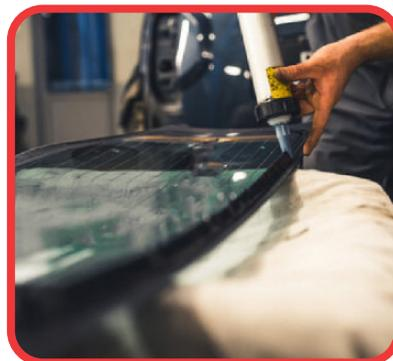
É um adesivo a base de poliuretano, ideal para colagem e vedação de vidros automotivos (carros e vans), máquinas agrícolas e blindagens de veículos. Sua formulação de cura ultra rápida permite, após a substituição do vidro, a liberação dos veículos em 2h, proporcionando um trabalho rápido, prático e profissional.
